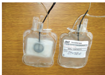
Obr. 1: Ukázka transfúzních vaků s instalovanými teplotními čidly. Patrný je fixační středový kroužek, zajišťující polohu čidla ve středu vaku.
